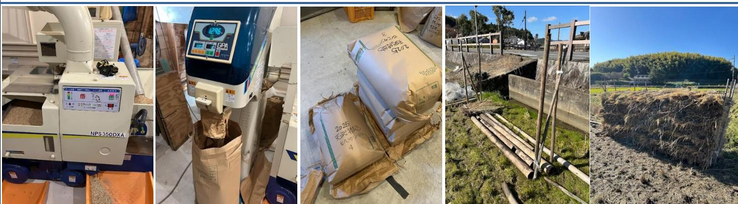
乾燥できた粒は粒摺り機、米選機を通して玄米に仕上がります。複数の機械による流れ作業のため、慣れるまで大変でした。また、品種を変えるごとにお米が混ざらないように掃除する必要があります。一年を通して全ての機械で起こりえるトラブルとその対処、メンテナンスの重要性など機械の知識も非常に深りました。
